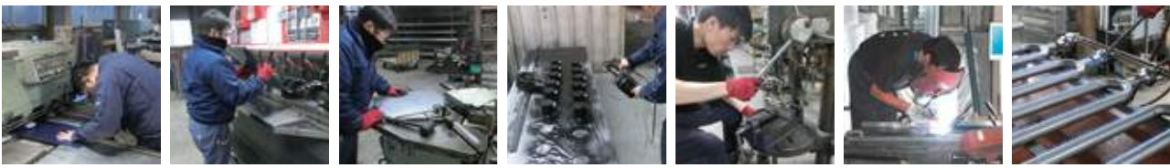
〈ステンレス切断〉 〈ステンレス折曲げ〉 〈コーナー部加工〉 〈塗装〉 〈バーナー加工〉 〈バーナー溶接〉 〈器具検査〉
