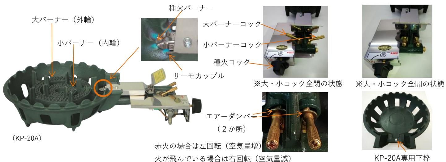
「種火立ち消え安全装置」は「立ち消え安全装置」のよう、本体の火が消えた場合にガスを遮断するものではありません。あくまでも種火バーナーの火が消えることにより、サーモカップルが反応しガスを遮断するものです。
